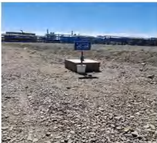
图 6.3-1 地下水监测井
