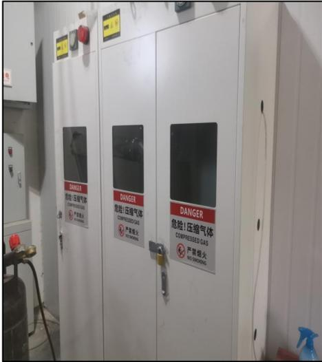
压缩气体箱（单体燃烧试验配套设施）
