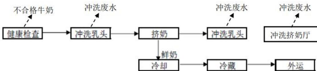
图 2.5-1 牛奶生产工艺流程图
